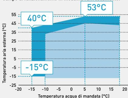
Campo di funzionamento in modalità riscaldamento.
