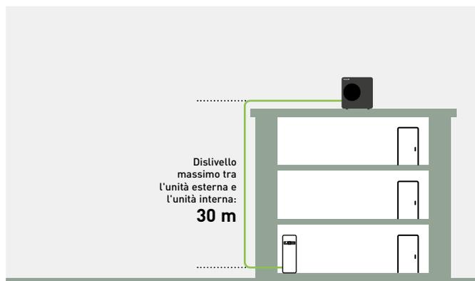
\* Per la serie L solo quando l'unità esterna è installata sopra l'unità interna e la pressione dell'acqua non supera 1 bar sull'unità esterna.
