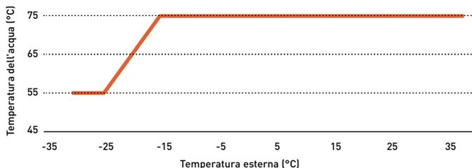
\* Per i modelli da 9, 12 e 16 kW della serie M. Per la serie L funzionamento con temperatura fino a -25 °C e uscita dell'acqua a 75 °C con temperatura ambiente fino a -10 °C.
