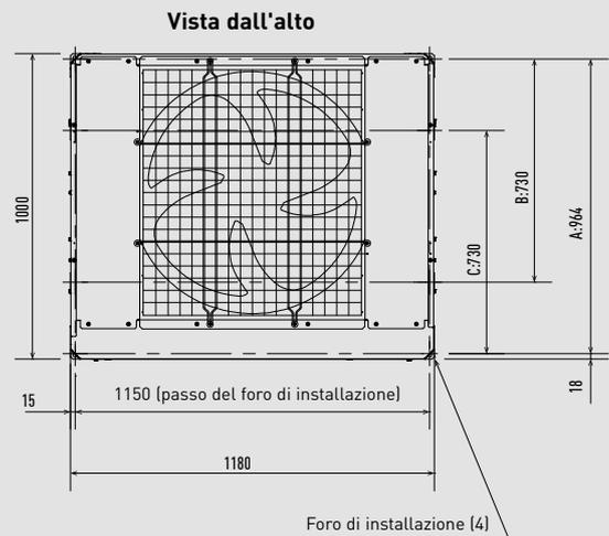
In base al sito di installazione, è possibile scegliere la posizione di impostazione nella direzione della profondità del bullone di ancoraggio tra A, B o C.
