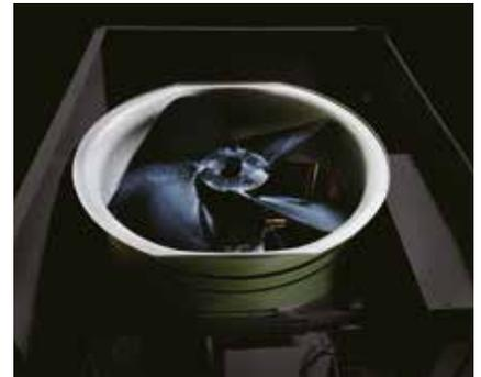
Apertura di scarico dell'aria ricurva a forma di campana per una migliore aerodinamica.
