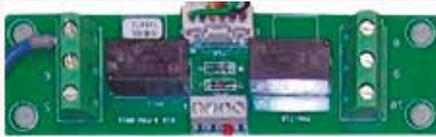
Scheda di controllo PCB di interfaccia T10 con connessioni digitali e a relè.
