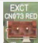
Cavo con forzatura spegnimento termostato/rilevamento perdite.
