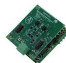
Interfaccia di pompa di calore
